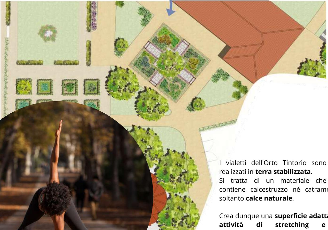
I vialetti dell'Orto Tintorio sono stati realizzati in **terra stabilizzata**. Si tratta di un materiale che non contiene calcestruzzo né catrame ma soltanto **calce naturale**.
