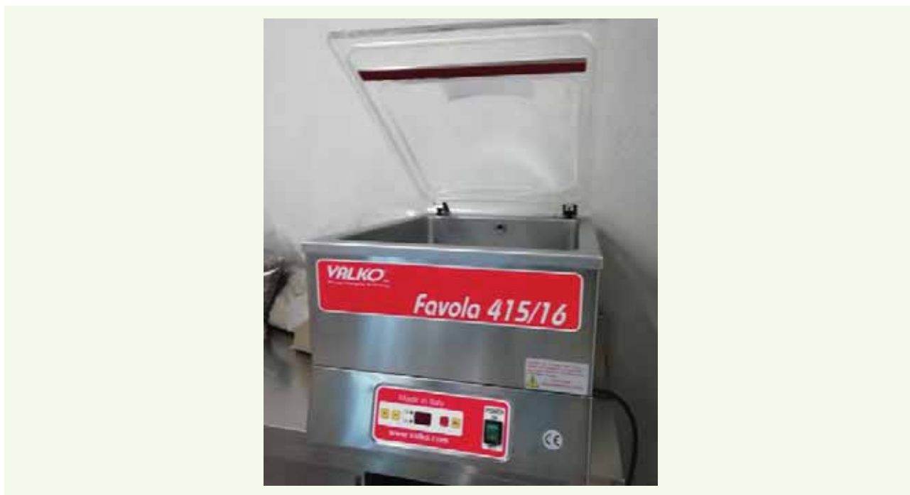
Figure 45 : Fardeleuse manuelle à cloche sous vide compensé utilisée pour le conditionnement des plantes séchées.
