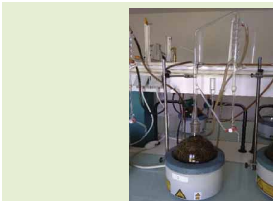
Figure 2 : Montage d'hydrodistillation de type Clevenger, CRIEPPAM.
