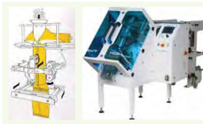
Figure 44 : Schéma de fonctionnement d'une machine de conditionnement flow pack verticale (« vertical form fill seal » - VFFS) et machine utilisée pour le conditionnement des herbes séchées.
