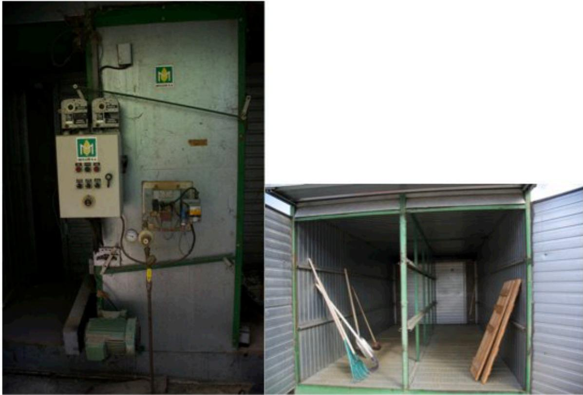
3 antichi essiccatori a tabacco, pannello elettrico con il sistema integrato e essiccazione d'origine (tranne l'iniezione di umidità soppressa) e l'interno di un essiccatore con pavimento a griglia metallica (struttura 3)
